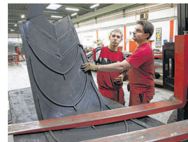
Mitarbeiter arbeiten an einem Förderband mit stark ausgeprägtem Profil. Foto: Dietmar Wäsche
